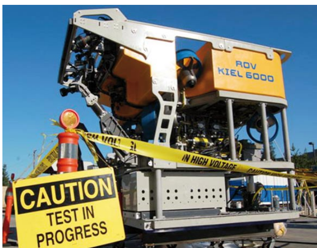
Zertifiziertes Heavy Duty Work Class ROV für Tauchtiefen bis 6.000 m
