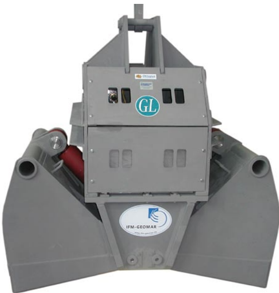
Zertifizierter TV-Greifer, für Tauchtiefen bis 6.000 m
