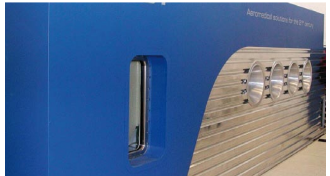
Unterdruckkammer für die Höhensimulation: Prüfung und Zertifizierung durch den GL auf Anfrage des Herstellers
